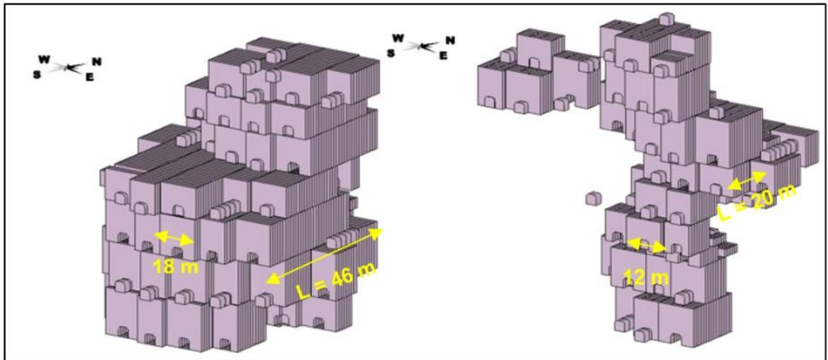
**Figure 13-21: Transverse sublevel stoping in Tomasa orebody**
